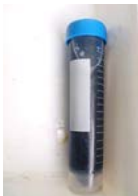
Fotografía 5. Disolución azul para la medida de la dureza del agua.
